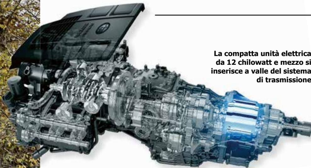
La compatta unità elettrica da 12 chilowatt e mezzo si inserisce a valle del sistema di trasmissione
