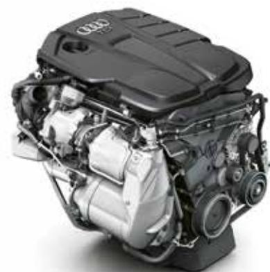
**Sopra, il motore "40 Tdi" da due litri porta "Q5" a offrire una potenza massima di 204 cavalli e una coppia di 400 newtonmetro**
