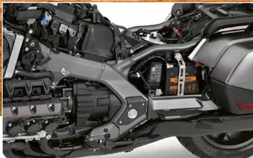
**A fianco, dettaglio del telaio di "Gold Wing 2020", costituito da una doppia trave di alluminio realizzata per pressofusione. La struttura è stata ottimizzata per realizzare un posizionamento più avanzato del motore rispetto ai modelli precedenti**
