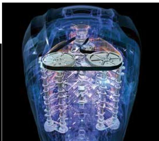
**A sinistra, il sistema di scarico ottimizza la spinta espellendo i gas tramite tre percorsi diversi. Sopra, il sistema di distribuzione a quattro valvole per cilindro**
