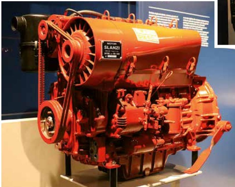
**Le unità "Ldr 108/2" del 1950 da due mila 564 centimetri cubi di cilindrata e 25 cavalli di potenza erogati a mille 500 giri al minuto fecero parte dei motori diesel verticali che insieme alle unità della serie "Ldo" caratterizzarono la produzione Lombardini negli Anni 50. Equipaggiati con iniezione in precamera, raffreddamento con radiatore e pompa, lubrificazione forzata e avviamento a manovella, furono sviluppati per assecondate applicazioni agricole e industriali** ↓
