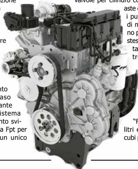
corpo i filtri doc e dpf. L'alimentazione è a iniezione diretta, attuata tramite un common rail operante a mille 600 bar, mentre l'aspirazione è forzata da un turbocompressore asservito o meno da un aftercooler a seconda della taratura di potenza. Il sistema di distribuzione è a due valvole per cilindro comandate da
