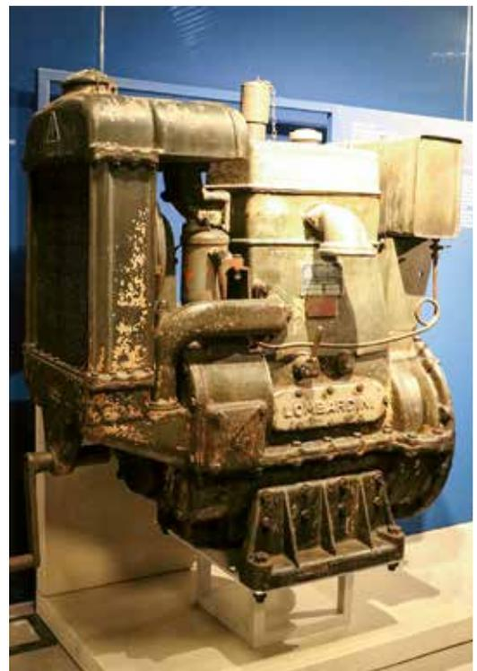
→ **"15LD440", 1988. 441 centimetri cubi e 10 cavalli di potenza sviluppati a tre mila 600 giri. Costruito nello stabilimento Intermotor di Rieti era un monocilindro dal design moderno. Disponeva di decompressione automatica ed elettro-stop e fu usato per azionare piccole attrezzature agricole e compattatori stradali**
